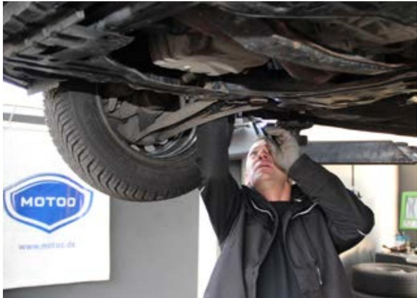
Ein Kunde kommt nach einem Bordsteinrempler mit defekter Felge in die Werkstatt. Der erfahrene Techniker prüft deshalb auch sofort die Lenkung und Fahrwerksteile auf Beschädigungen.
