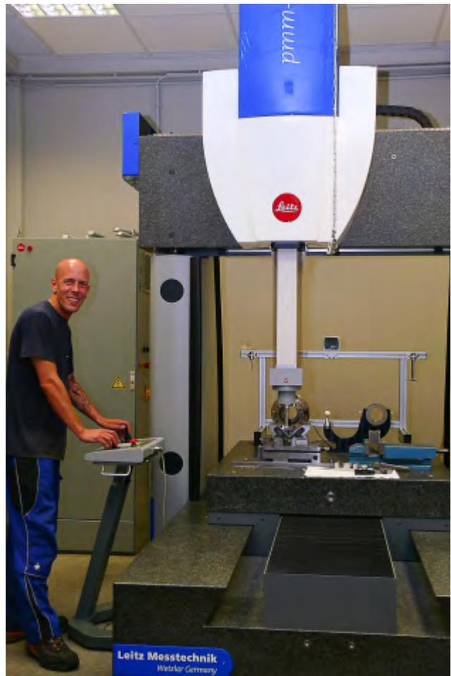
Björn Laabs überprüft mit der Leitz-Messtechnik die Bauteile, aus denen im Schweizer Werk die Spindeln montiert werden.
