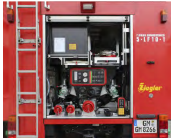
Die Welt moderner Löschtechnik: In den seitlichen Laderäumen sind Schläuche, die mobile Tragkraftspritze, Werkzeuge, Kleinlöschmaterial, ein 8 kW Stromaggregat, Motorsäge, Trenn- von 8,4 Metern und der doppelflügelige Halogen-Lichtmast. Das Heck ist von der großen Feuerlöschkreiselpumpe ausgefüllt. Dahinter verbirgt sich der 1200 Liter Wassertank. Im Fahrer-
