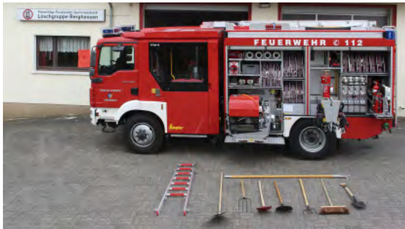
Die Welt moderner Löschtechnik: In den seitlichen Laderäumen sind Schläuche, die mobile Tragkraftspritze, Werkzeuge, Kleinlöschmaterial, ein 8 kW Stromaggregat, Motorsäge, Trenn- von 8,4 Metern und der doppelflügelige Halogen-Lichtmast. Das Heck ist von der großen Feuerlöschkreiselpumpe ausgefüllt. Dahinter verbirgt sich der 1200 Liter Wassertank. Im Fahrer-
