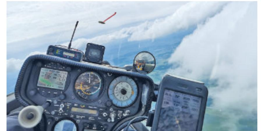
Blick aus dem Cockpit: Der rote Faden ist wichtigstes "Instrument", um zu sehen, ob das Flugzeug gerade in der Luftströmung liegt.
