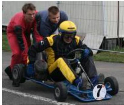
Einer rechts, einer links und nach ein paar schnellen Schritten fallen lassen: So wird ein Kart gestartet. Bild: Stöcker
